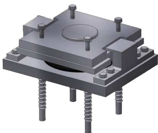
桁架設時(可動支承として機能)
