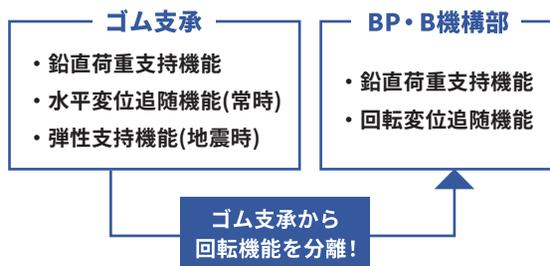
BP・B機構部の密閉ゴムの変形により橋桁の回転変位を吸収するため、ゴム支承自体には回転の影響が伝達されない。
