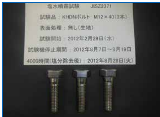
塩水噴霧試験4000時間終了後の状況
