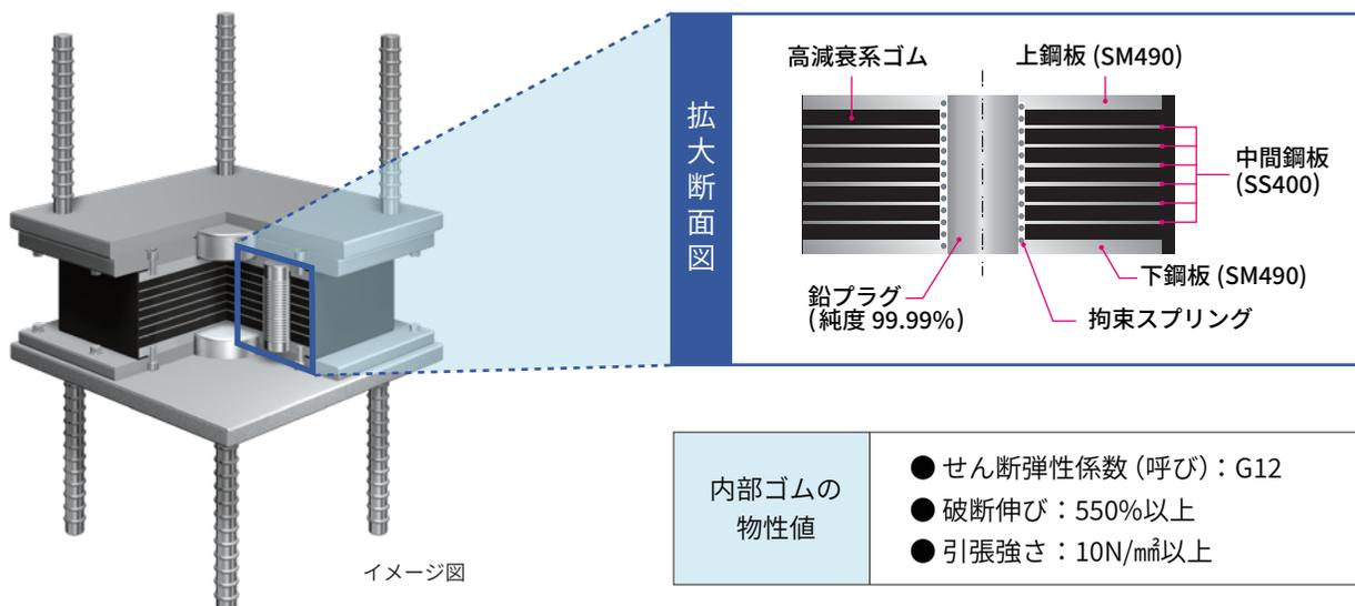
鉛プラグの挙動を安定化させ、減衰の安定化と繰り返し荷重に対する耐久性の向上を図りました。コンクリート橋、鋼橋ともに適用可能。新設の支承設置工事、既設橋梁の支承取替え工事（耐震化工事）にも適用可能です。
