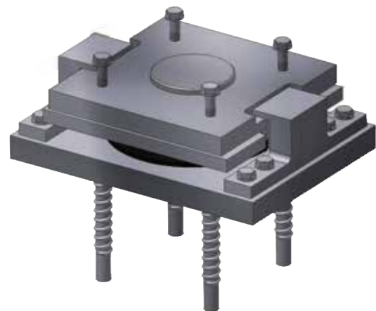
桁架設時(可動支承として機能)
