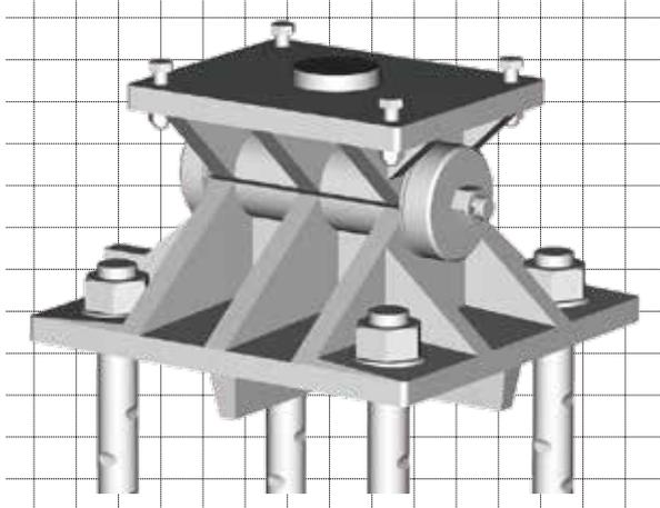
上沓と下沓を円柱状のピンで連結した構造で、一方向のみに回転可能な固定支承です。ピンの支持方法によって支圧型とせん断型の2種類に分けられ、ピンに対して鉛直荷重を面で伝える「支圧型」が一般に多く使用されていますが、「せん断型」は特に負反力が大きい場合などに適しています。上路式アーチ橋やπ型ラーメン橋の基部、高橋脚のヒンジとして使われますが、橋軸直角方向の回転が生じる橋梁形式には不向きです。
