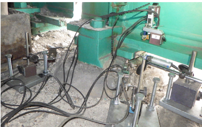
接触式変位計 設置状況
