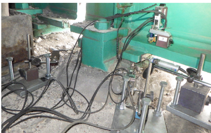
接触式変位計 設置状況
